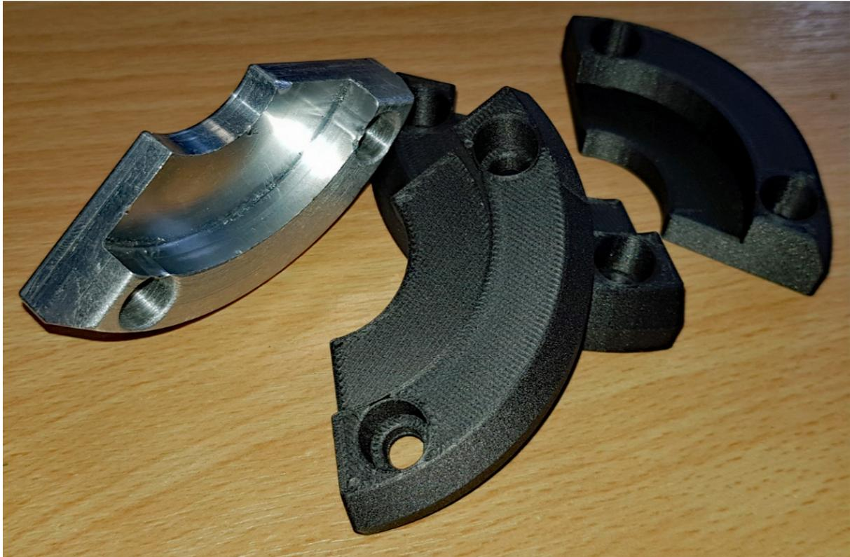
Ein aus FDM Nylon 12CF hergestelltes, 3D-gedrucktes Backenzubehör - diese Bauteile sparen bis zu 80% der Maschinenrüstzeit.
